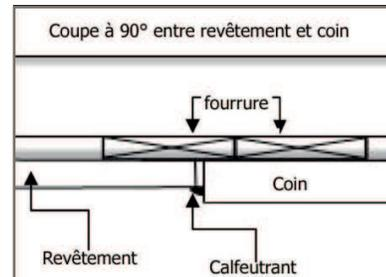
La finition des coins de murs en coupant les planches à 45° plutôt qu'en utilisant un coin de bois ou de métal n'est pas recommandée. Elle favorise l'infiltration et écourte la durabilité du bois.
